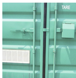
Sistema di chiusura ad aste lucchettabili
