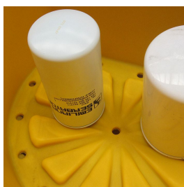
Boccaporto con piano scolafiltri
