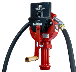
Contaltri per pompa rotativa manuale
